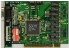
Core: S3 Trio32 ?MHz 32bit Memory: 1MB ?MHz 32bit
