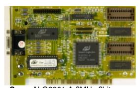
Core: ALG2301.A ?MHz ?bit Memory: 1MB ?MHz ?bit Year: 1994 Bus: PCI
