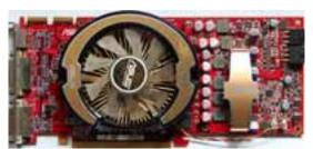
**Core:** RV770 750MHz **Shaders:** 800 **Memory:** 512MB DDR5 3600MHz 256bit
