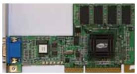
Core: ATI Rage 128 VR 80MHz 128bit Memory: 8/32MB SDR 60MHz 64bit
