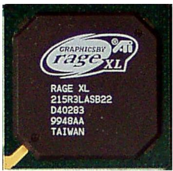
Core: ATI Rage XL ?MHz 64bit Memory: 8MB SDR 74,82MHz 64bit
