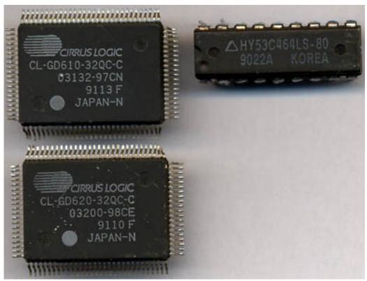
**Core:** CL-GD610/620 32MHz ?bit **Memory:** 256kB (1MB max) 33MHz 16bit
