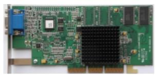
Core: ATI Rage 128 Pro GL 120MHz 128bit Memory: 16MB SDR 120MHz 64bit
