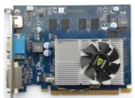
Core: G96GS 550MHz 256bit Shader: 1375MHz Memory: 512MB DDR2 1020MHz 128bit
