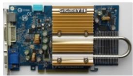
Core: G73 450MHz 128bit Memory: 256MB DDR2 800MHz 128bit Year: 2006 Bus:
