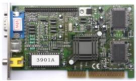
**Core:** 86C390 100MHz 128bit **Memory:** 8MB SGRAM 120MHz 64bit
