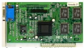
Core: Permedia 2V ?MHz 64bit Memory: 4MB SGR ?MHz 64bit
