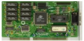
Core: ALG2101 ?MHz ?bit Memory: 1MB ?MHz ?bit
