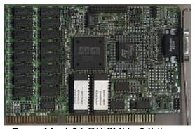
Core: Mach64 GX ?MHz 64bit Memory: 2MB DRAM ?MHz 64bit
