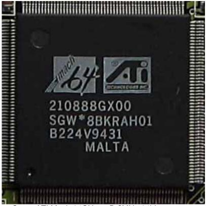
Core: ATI Mach 64GX rev.D ?MHz 64bit
