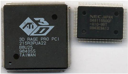
Core: ATI 3D Rage PRO PCI 74,82MHz 64bit
