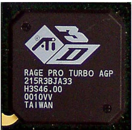
Core: ATI Rage Pro Turbo AGP 75MHz 64bit Memory: 4/8MB SDR/SGR 100MHz 64bit
