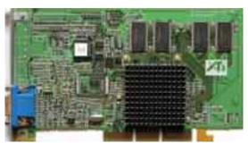
Core: ATI Rage 128 Pro 120MHz 128bit Memory: 32MB SDR 120MHz 64bit
