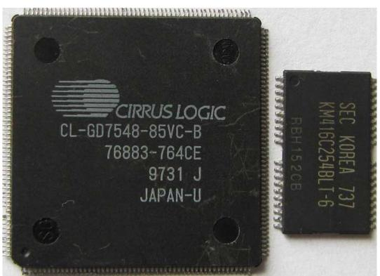
Core: CL-GD7548 ?MHz ?bit Memory: 1MB DRAM ?MHz 32bit
