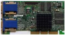
Core: G450 (Condor) 118MHz 256bit Memory: 32MB DDR 294MHz 64bit
