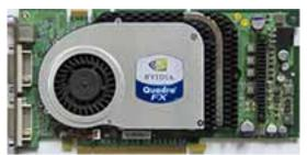
Core: NV40 (NV45GL) 351MHz 256bit Memory: 256MB GDDR3 898MHz 256bit
