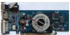
Core: G86 450MHz Shaders: 16 at 900MHz Memory: 256MB GDDR2 800MHz 64bit
