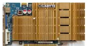
**Core:** G86 500MHz 16 shaders at 1404MHz **Memory:** 256MB DDR2 800MHz 128bit
