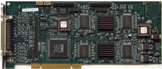
**Core:** 2xNV3 (Riva 128) 100MHz 128bit **Memory:** 2x4MB SGR 100MHz 128bit
