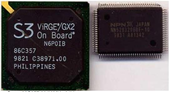
**Core:** 86C357 80/90MHz 64bit **Memory:** 4MB SGR 80/90MHz 64bit
