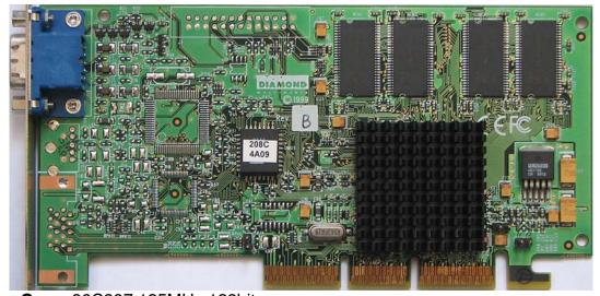
**Core:** 86C397 125MHz 128bit **Memory:** 8/32MB SDR 143MHz 64bit
