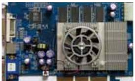
Core: XGI Volari V8 280MHz 256bit Memory: 128MB DDR 500MHz 128bit
