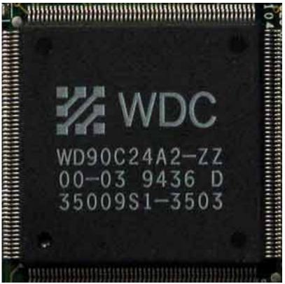
Core: WD90C24A2-ZZ ?MHz ?bit Memory: 1MB FPM 50MHz 16/32bit
