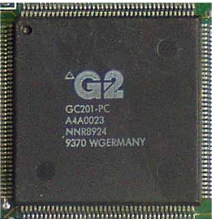
Core: GC201-PC ?MHz ?bit Memory: 256kB ?MHz ?bit Year: 1987 Bus: ISA 8bit
