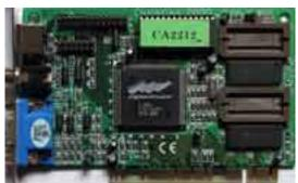
Core: ExpertColor T2000 ?MHz 64bit Memory: 1MB EDO 69,203MHz 128bit
