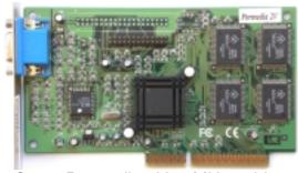
Core: Permedia 2V 83MHz 64bit Memory: 4MB SGR ?MHz 64bit
