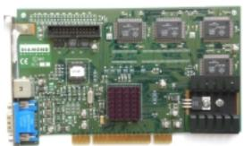
Core: Permedia 2 100MHz 64bit Memory: 8MB SGR 100MHz 64bit
