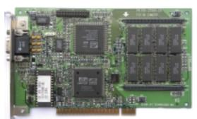
Core: ATii Mach64 GX ?MHz 64bit Memory: 4MB DRAM ?MHz ?bit Year: 1994 Bus: PCI
