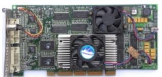
**Core:** IBM GT1000 205MHz 256bit + IBM RC1000 150MHz 256bit **Memory:** 128MB DDR 300MHz 256bit
