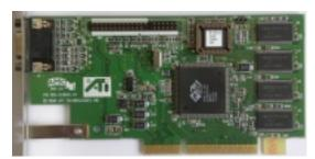
Core: ATI Rage IIC AGP 75MHz 64bit
