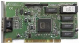
Core: ATi-264VT2 63MHz Memory: 2MB EDO 60MHz Year: 1996 Bus: PCI
