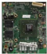
Core: ATi M71 480MHz 256bit Shader: 480MHz
