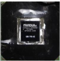
Core: G86GLM 400MHz 128bit Shader clock: 800MHz
