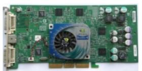
Core: NV28GL 300MHz 128bit Memory: 128MB DDR 500MHz 128bit Year: 2002 Bus: AGP 4x
