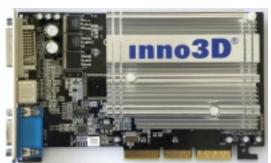
**Core:** NV18 275MHz 256bit **Memory:** 64MB DDR 400MHz 128bit **Year:** 2002 **Bus:** AGP 8x **Made:** TSMC 0,15 μm Korea
