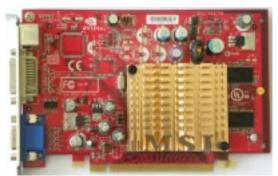
Core: NV44 350MHz 256bit Memory: 64MB DDR 550MHz 128bit or 128MB DDR 500MHz
