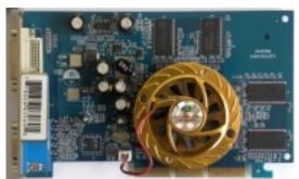
Core: NV34 250MHz 256bit Memory: 64/128MB DDR 333/400MHz 64/128bit
