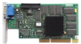
Core: NV4 90MHz Memory: 16MB SDR 110MHz 128bit
