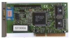
Core: 86C365 100MHz 128bit Memory: 4MB SGR 100MHz 64bit
