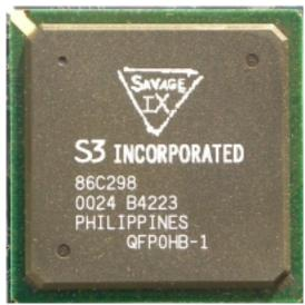
**Core:** 86C298 100MHz 128bit **Memory:** 8MB SDR 133MHz 64bit
